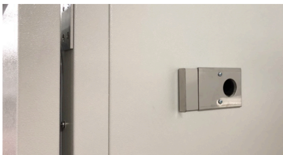
ORIFICIOS LATERAL O SUPERIOR, (SEGÚN MODELO) Y POSTERIOR PARA LA EVACUACIÓN DE LA HUMEDAD GENERADA EN LA CÁMARA Y COMO PUERTO DE ACCESO PARA SONDA EXTERNA
